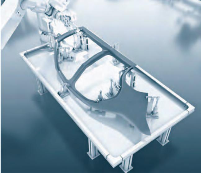
**Pneumatisch betriebene Spannvorrichtungen fixieren ein Karosserieelement aus der Automobilindustrie für den Schweißvorgang. (Foto: Festo)**
